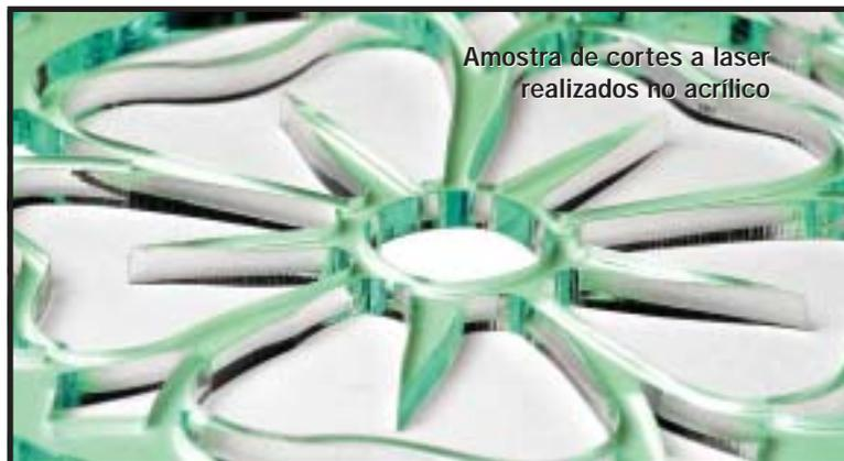
Amostra de cortes a laser realizados no acrílico
